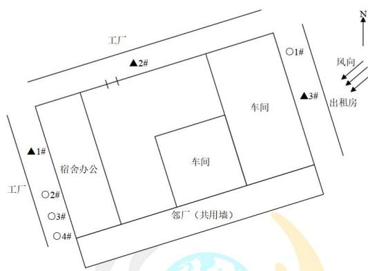
监测点位分布示意图：○表示无组织废气监测点，▲表示噪声监测点
